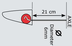
Made in prepreg carbon, our rudder lines are delivered with a stainless steel axle (**anti-Torn off**) preformed axle integrated. Construites en carbone pré-preg, nos dérives sont montées sur un axe pré-formé (**anti-arrachement**) en acier inoxydable.
